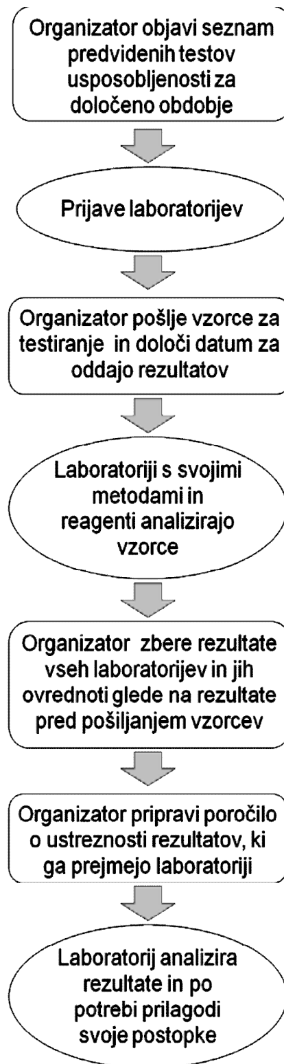
Slika 1: Shema poteka testa usposobljenosti na osnovi FAPAS®. V pravokotnih okencih so navedene naloge organizatorja, v elipsah pa naloge posameznega laboratorija.
