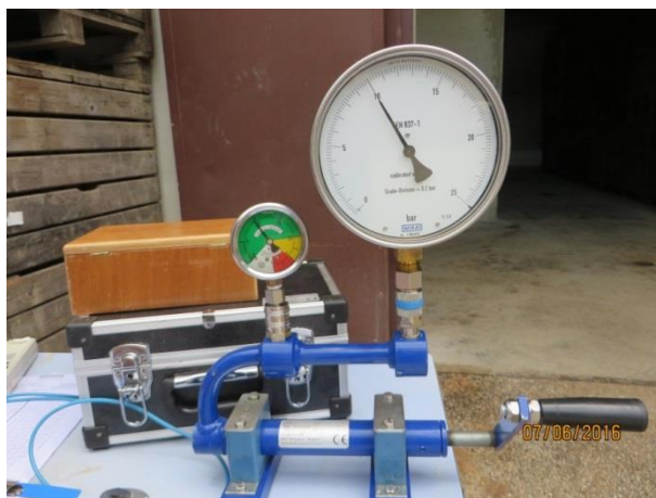
Slika 1: Meritev točnosti manometrov.
